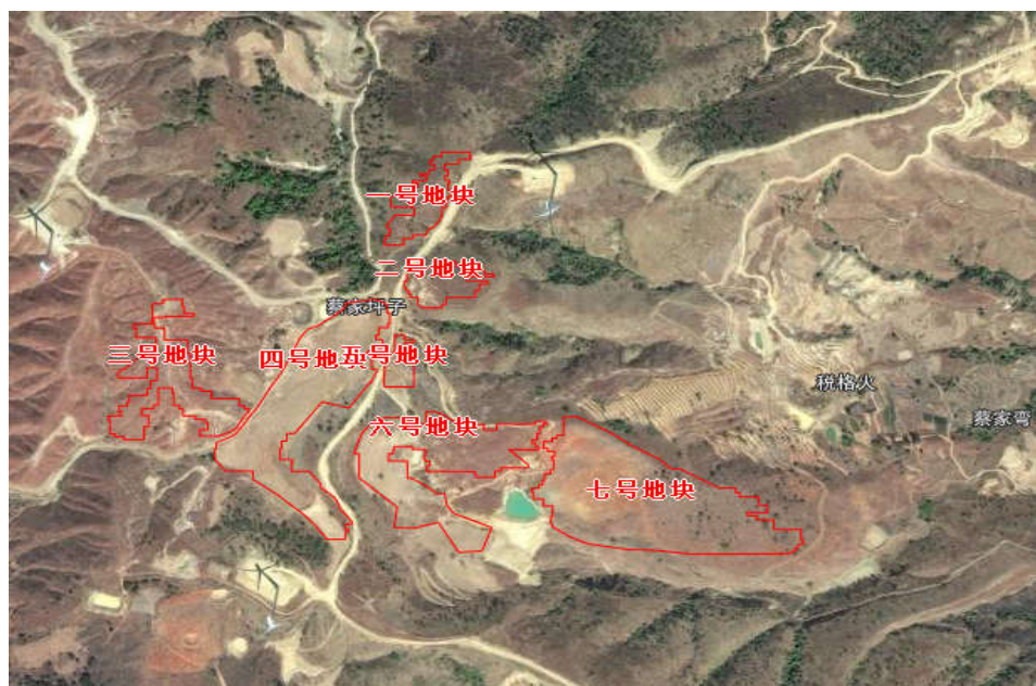
图 1.1 1-7#地块原地貌图（布置 1-9 号光伏阵列）
